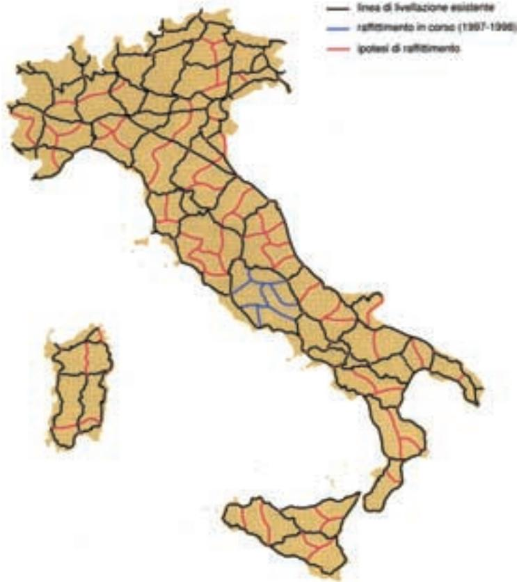
Figura 16 - Rete nazionale di livellazione geometrica di alta precisione.
