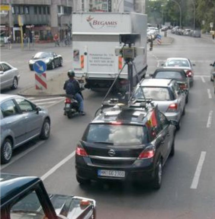
Figura 16. Veicolo dotato di strumenti per il rilievo fotografico 360°
