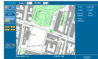
La realizzazione di un nuovo cantiere viene segnalata inserendo, tramite lo strumento di puntamento, un elemento puntuale direttamente sulla mappa visualizzata e compilando il layout predisposto per i dati alfanumerici del Data Base
