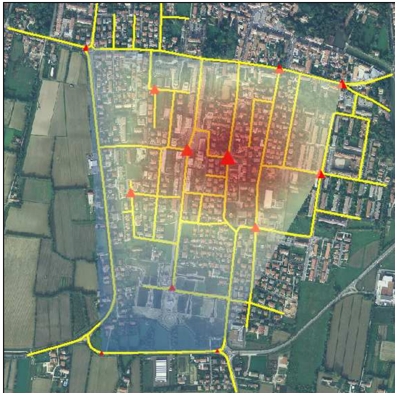
Rete fognaria di Feltre con localizzazione e mappatura della sensoristica e relativi valori di portata
