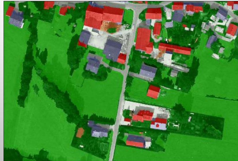
La classificazione **object-based** valorizza l'elevato contenuto informativo della componente geometrica delle immagini telerilevate.
